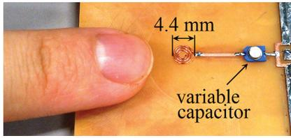
Fig. 5. Prototype antenna.
